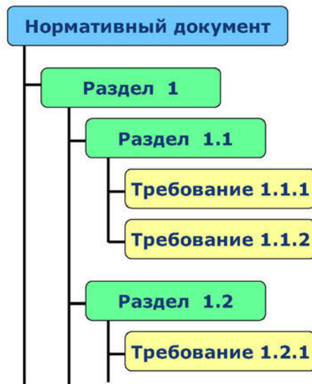
Рис. 1. Схема описания сертификационного базиса в виде дерева требований
